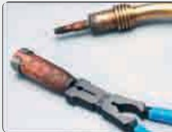
• Entfernen der Schweißspritzer innerhalb der Gasdüse
