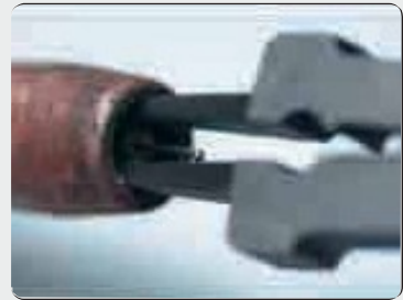
• Entfernen der Schweißspritzer inner- bzw. außerhalb der Gasdüse
