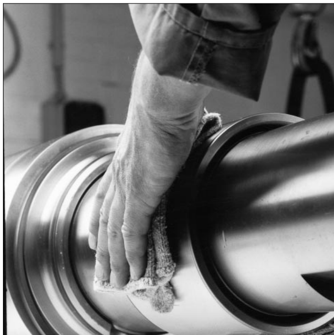
41: Angewärmte Lagerteile schiebt man schnell und ohne Verkanten bis zum Anschlag auf. Erleichtert wird dies durch eine leicht schraubende Drehung.
