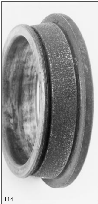
115: Ätzflecken in der Rollbahn eines Pendelrollenlager-Außenrings
