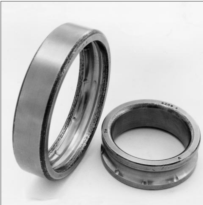
108: Durch unsachgemäße Montage hervorgerufene Rollkörpereindrücke in den Rollbahnen eines Rillenkugellagers
