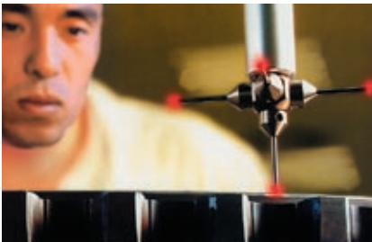
Höchste Qualität in der Großserie: Mess-Sonde für den \mu\text{m} -Bereich
