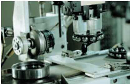
Vollautomatisch: Aus Innenring, Außenring, Kugeln, Käfig und Fett entsteht ein komplettes Wälzlager
