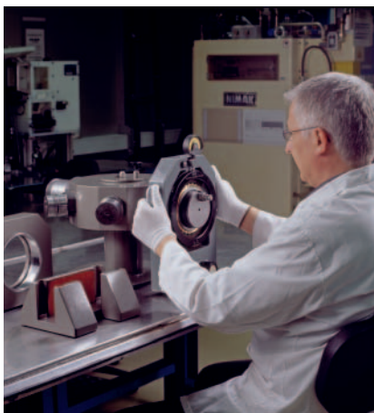
11: Aufsetzen des Hüllkreismessgerätes
