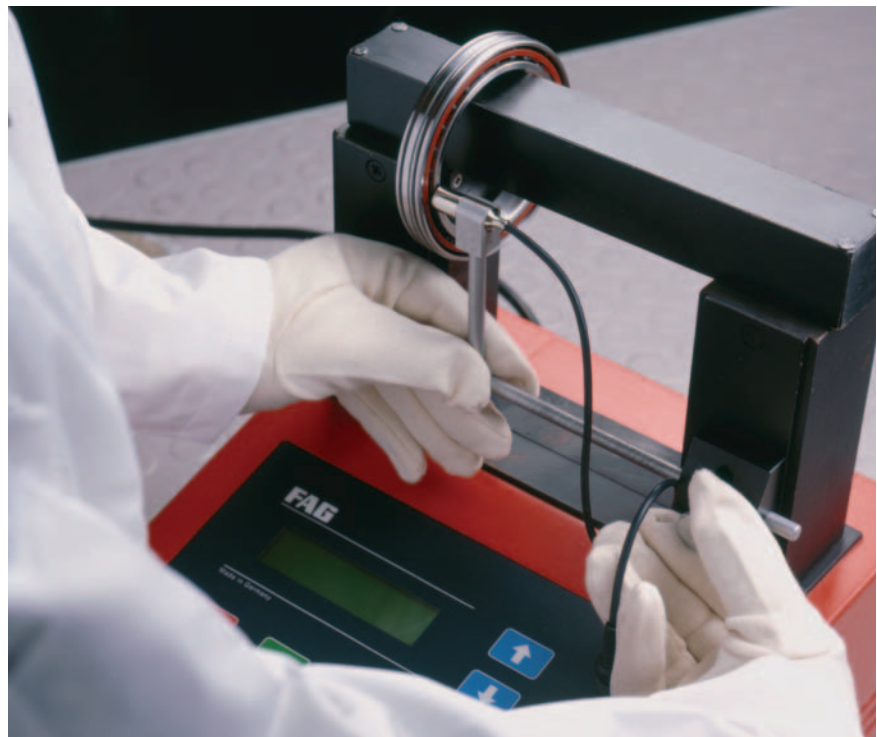
3: Anwärmen eines Spindellagers mittels eines induktiven Anwärmgerätes
