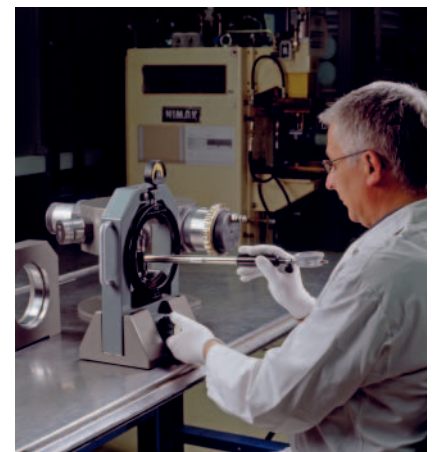
10: Übertragen des Laufbahndurchmessers auf das Hüllkreismessgerät
