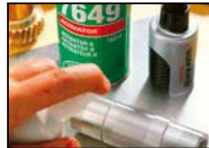
Loctite® 7649 - Aktivator Aktivator zur besonders starken Beschleunigung der Aushärtung bei anaeroben Kleb- und Dichtstoffen. Zur Unterstützung der Aushärtung bei 5 – 15 °C.
