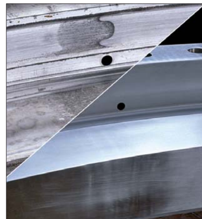
8: Vorher: Laufbahn mit starker Narbenbildung im Bereich der Schlupfstelle Nachher: Nachgeschliffene Laufbahn
