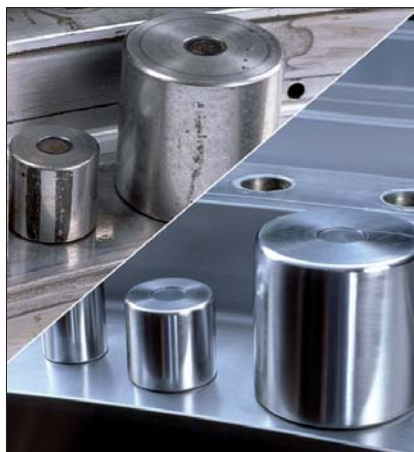
6: Vorher: Rollen mit Korrosionsspuren und Fremdkörpereindrücken Nachher: Neue Rollen mit angepasstem Übermaß
