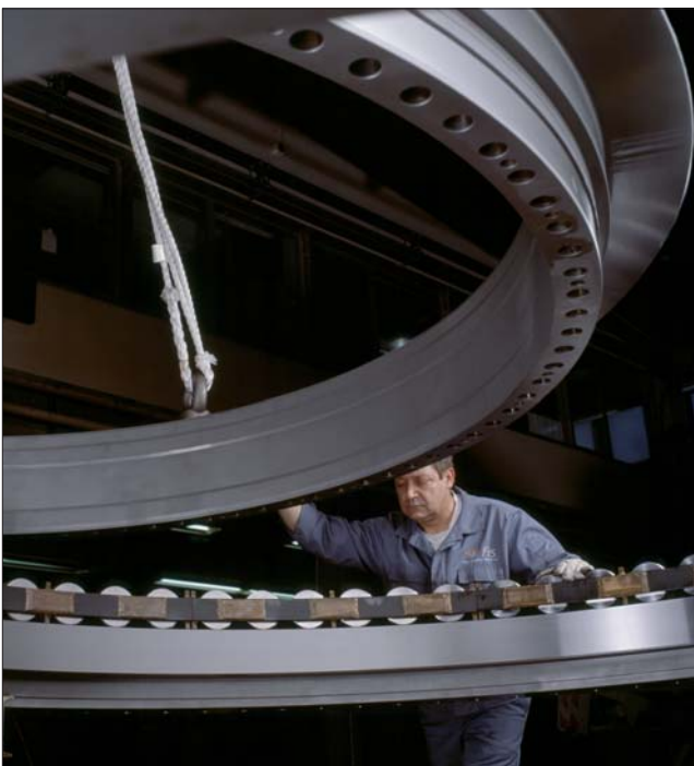
1: Montage eines aufbereiteten Tunnelbohrmaschinenlagers
