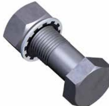
Parker Verbunddichtscheiben der Serie WT sind ausgelegt um direkt auf dem Gewindegang abzudichten. Die Dichtlippen verschließen den Leckage-Pfad der Gewindegänge. Die Dichtscheiben verfügen über eine Selbstzentrierung. Die Elastomer-Dichtlippe ist wie bei Profil WO chemisch und mechanisch mit dem Metallträger verbunden.
