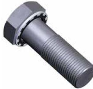
Parker Verbunddichtscheiben der Serie WO sind für die radiale Abdichtung unterhalb des Schraubenkopfes, im Bereich des glatten (gewindelosen) Schraubenschaftes, konzipiert. Dadurch entstehen drei funktionsrelevante Dichtstellen. Die Elastomer-Dichtlippe ist chemisch und mechanisch mit dem Metallträger verbunden. Die Serie WO ist selbstzentrierend.
