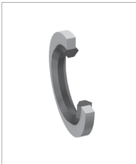
Die Verbunddichtscheibe WU besteht aus einer Metallscheibe mit rechteckigem Querschnitt und einer an der Innenseite anvulkanisierten Elastomer-Dichtlippe mit diamantförmigem Querschnitt. Sie ist eine Weiterentwicklung der Serie WX und bietet eine optimierte Pressungsverteilung im Dichtungsquerschnitt.
