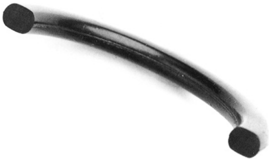
Bild 10.8 Schadensbild durch hohe bleibende Verformung (Compression Set)
