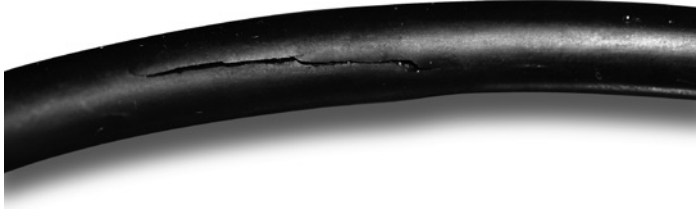
Bild 10.11 Oberflächenzerstörung durch explosive Dekompression
