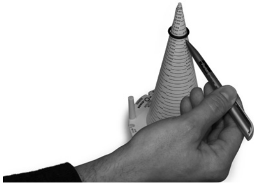
Bild 5.8 Bestimmung der Größe mit dem Messkegel
