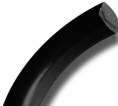
Bild 10.12 Schäden durch Abrieb als einseitige Abflachung an der Innenseite erkennbar
